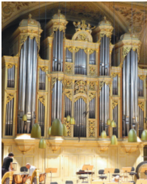
Kleuker und Steinmeyer, 1988 Schleifwindladen Spieltraktur mechanisch + elektrisch (mobiler Spieltisch) Registratur elektrisch Manualumfang: C-c 4 Pedalumfang: C-g 1
