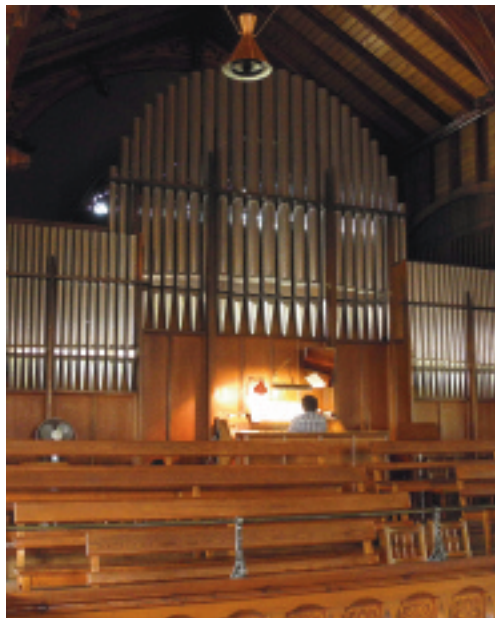
III/P/28 Orgelbau Kuhn AG, 1934 Hängeventilladen Spieltraktur mechanisch-pneumatisch Registratur pneumatisch Manualumfang: C-g 3 Pedalumfang: C-f 1
