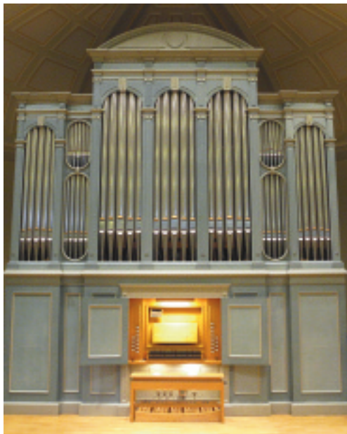
Orgelbau Kuhn AG, 1987 Schleifwindladen Spieltraktur und Registratur mechanisch Manualumfang: C-g 3 Pedalumfang: C-f 1
