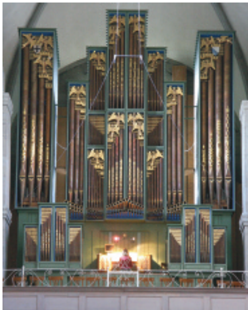
IV/P/67 Metzler Orgelbau AG, 1960 Schleifwindladen Spieltraktur mechanisch Registratur elektrisch
